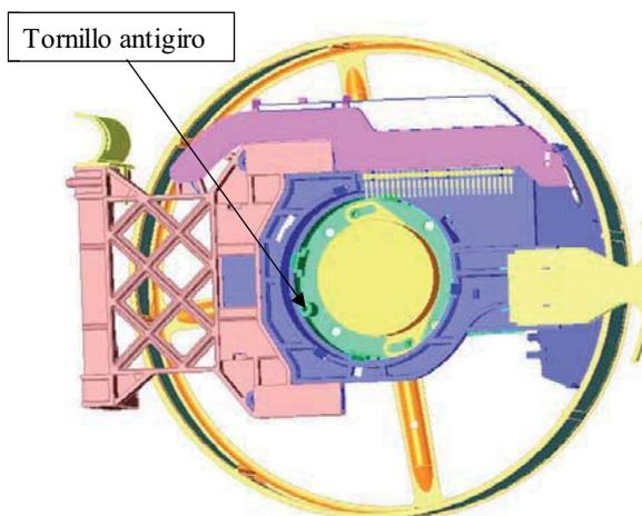
**Test 9:** Entre otras posibilidades se comprueba la correcta sincronización de los rodillos, inferiores o superiores, así como la parada en figuras iguales en los tres rodillos y su posición relativa a la línea de premios.
